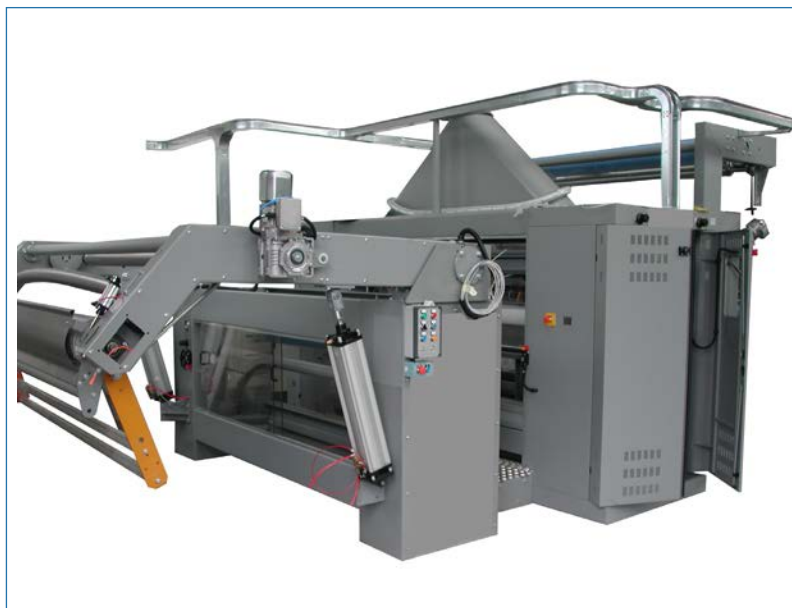
Immagini di due differenti macchinari al plasma a pressione atmosferica. La macchina raffigurata a sinistra può trattare campioni di altezza fino a 600 mm, quella a destra invece fino a 1800 mm
